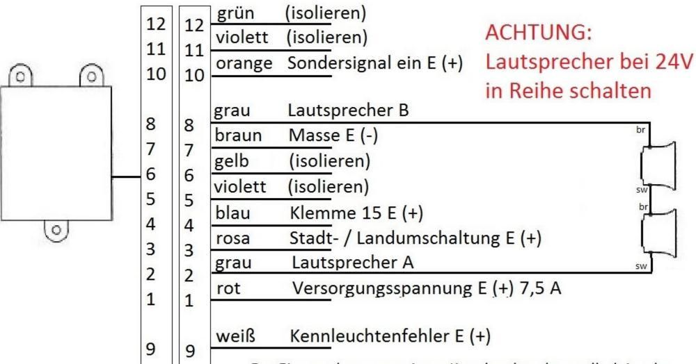
Der Eingang kann von einem Kennleuchtenkontrollrelais oder einem Kontrollausgang (+) angesteuert werden. Sollte kein Anschluss nach DIN gewünscht sein diesen Eingang auf Klemme 15 legen
