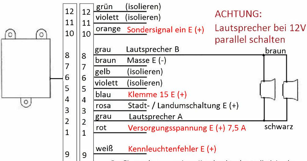
ROT gekennzeichnete Eingänge müssen mit +VDC belegt sein um das Sondersignal zu aktivieren Der Eingang kann von einem Kennleuchtenkontrollrelais oder einem Kontrollausgang (+) angesteuert werden. Sollte kein Anschluss nach DIN gewünscht sein diesen Eingang auf Klemme 15 legen
